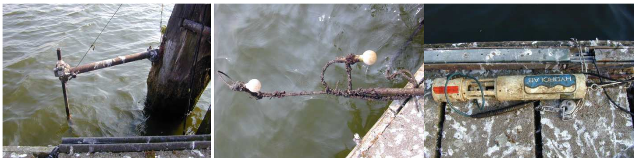
Bild6: Ausleger mit PAR-Sensoren; Bild7+8: typischer Bewuchs an PAR-Sensoren und Multiparametersonde
